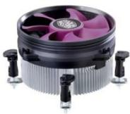
X Dream i117 è un dissipatore low profile realizzato in alluminio. Ha un'altezza di soli 60mm ed è concepito per CPU Intel. Il suo design è capace di centralizzare il flusso d'aria e massimizzare la dissipazione del calore. Il movimento della ventola garantisce un bassissimo rumore
